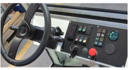
Der neue Elektroschlepper E200 soll als sicheres Zugfahrzeug für Anhänger bis zu einem Gewicht von **20t** in der Ebene verwendet werden. Er ist serienmäßig mit einem programmierbaren AC-Drehstromantrieb ausgerüstet, welcher die Vorteile Zuverlässigkeit, geringer Wartungsaufwand, größere Leistungsfähigkeit und feinfühligerem Rangieren miteinander vereint. Den E200 gibt es auch in der Version als **E-Plattformwagen** zum Tragen bis **2t** auf der Ladefläche.
