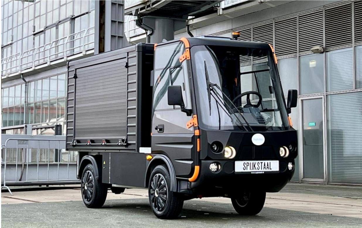
Der neue Elektrotransporter Typ 1200 ist ein reines Elektrofahrzeug und sondert 0% Emissionen im Fahrbetrieb ab. Er hat eine EU-weite **Straßenzulassung (N1)** und ist bis zu **55 km/h** schnell. Unbeladen hat er eine Reichweite bis 180 km\*. Zudem ist er ein Plattformwagen zum Tragen **bis 1250 kg auf der Ladefläche**. Er wird serienmäßig von einem Rahmen aus Aluminium getragen, der zugleich leicht und korrosionsbeständig ist.
